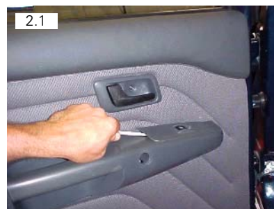
2.1 Soltar comando elétrico. Usar espátula plástica
