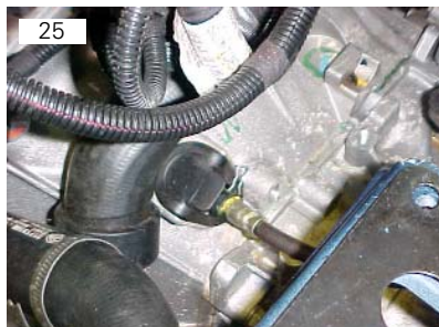
25 Cilindro de embreagem vai fixado por meio de uma trava
