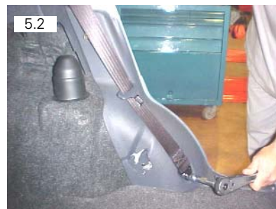
Remover parafuso M10 SEX17 de fixação do cinto e segurança
