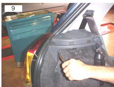
Remover três parafusos philips de fixação do suporte do porta-pacotes
