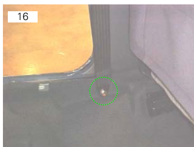
Localização do parafuso M10 SEX17 de fixação do cinto de segurança
