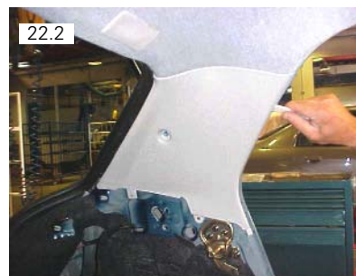
Soltar moldura superior da coluna C. Usar espátula plástica
