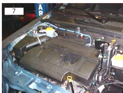
Cobertura do motor vai fixada por meio de parafusos
