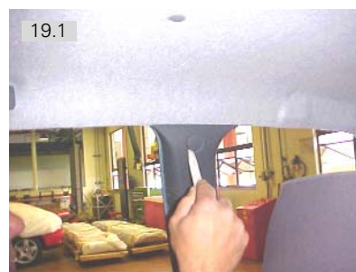
Soltar tampão de acabamento da moldura interna da coluna B. Usar espátula plástica
