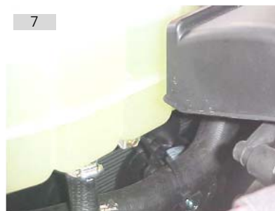
Localização da mangueira inferior do vaso expensor
