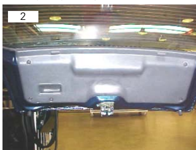
Moldura da tampa vai fixada por meio de travas e cinco parafusos, quatro philips e um allen 5 mm
