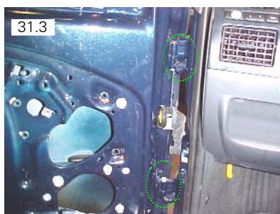
Porta dianteira é fixada por meio de dois parafusos M6 SEX10
