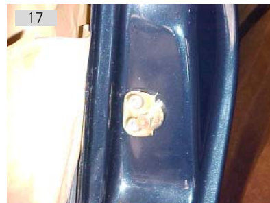
Trinco batente da porta traseira vai fixada por meio de dois parafusos Allen 5
