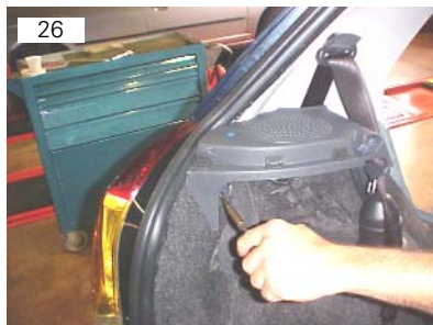
26 Remover três parafusos philips de fixação do suporte do porta-pacotes
