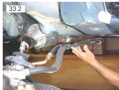
Soltar tubulação da direção hidráulica
