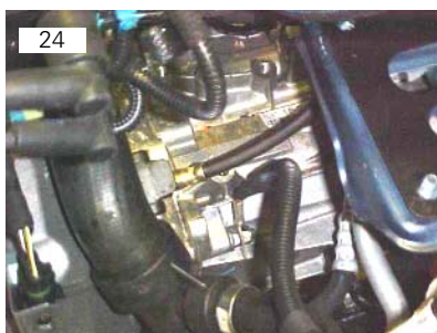
Cabo massa vai fixado por meio de um parafuso M6 SEX10
