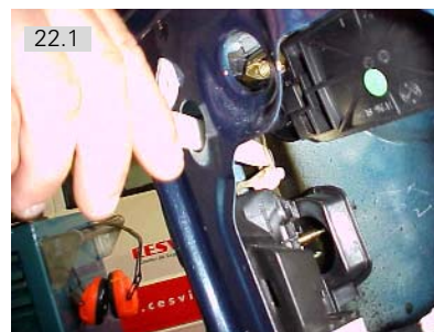
Soltar da haste de acionamento do conjunto trinco da porta. Usar espátula plástica
