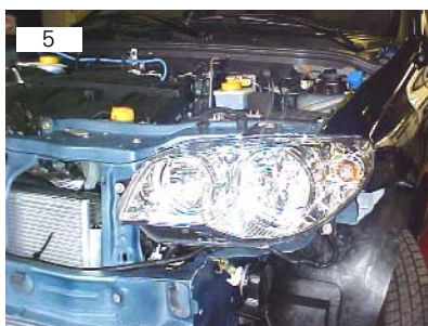
Conjunto óptico vai fixado por meio de três parafusos M6 SEX10
