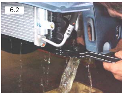
Afastar mangueira e drenar líquido de arrefecimento
