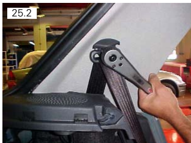
25.2 Remover parafuso M10 SEX17 de fixação do cinto de segurança
