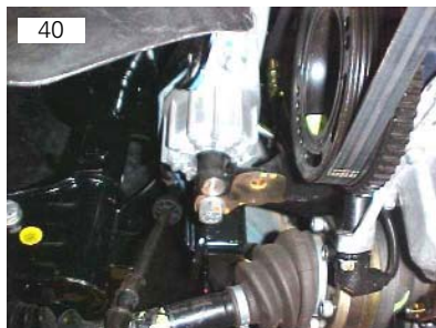
Coxim do motor vai fixado por meio de um parafuso M12 SEX19
