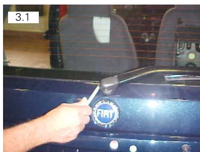
Soltar cobertura do braço do limpador traseiro. Usar espátula plástica
