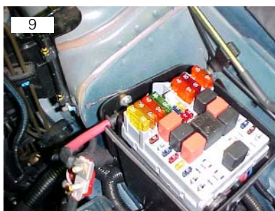
Placa de fusíveis vai fixada por meio de um parafuso M6 SEX10
