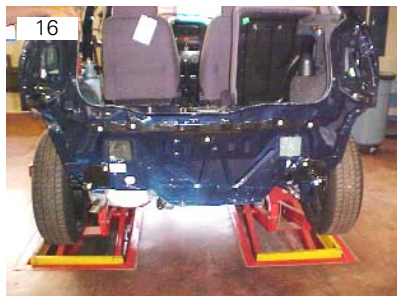
16 Suporte do pára-choque traseiro vai fixado por meio de cinco porcas M8 SEX13
