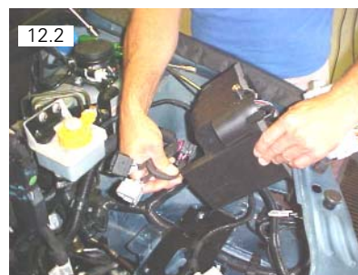
Remover caixa de fusíveis
