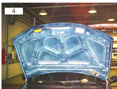
Capô vai fixado por meio de quatro parafusos M6 SEX10
