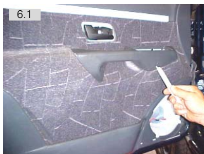
Soltar tampões de acabamento da moldura interna da porta. Usar espátula plástica
