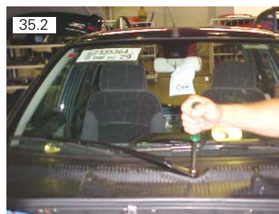
Remover porcas M8 SEX13 de fixação do braço dos limpadores dianteiros
