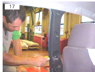
Soltar moldura interna da coluna B. Usar espátula plástica
