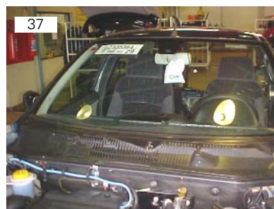
Grade inferior do pára-brisa vai fixada por meio de dez parafusos philips
