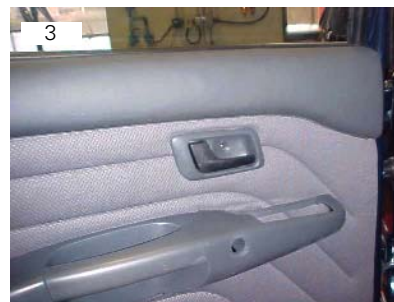
3 Moldura da maçaneta interna é fixada por meio de um parafuso philips rosca soberba
