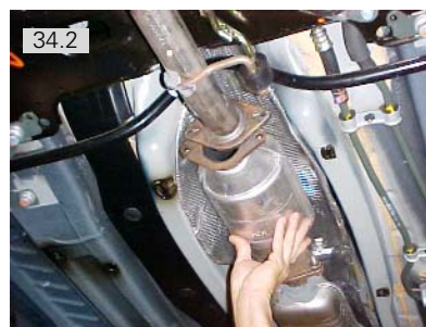
Soltar tubo primário do escapamento
