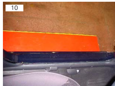
Moldura interna traseira da soleira vai fixada por meio de parafusos philips
