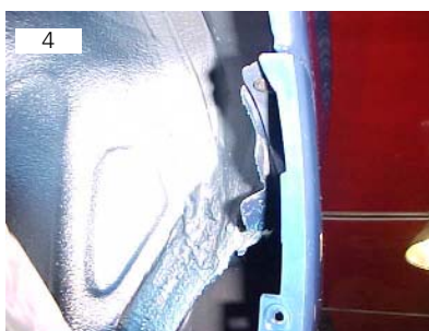
Pára-choque traseiro vai fixado nas laterais por meio de quatro parafusos torx 30, sendo dois de cada lado
