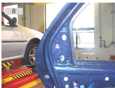
8 Moldura externa da porta vai fixada por meio de dois parafusos M6 SEX10
