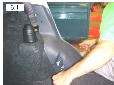
Soltar moldura inferior da coluna C. Usar espátula plástica
