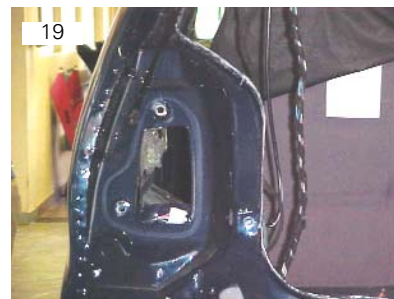
Alojamento da lanterna vai fixado por meio de pontos de solda por resistência. Corte na linha tracejada para efetuar esta substituição parcial
