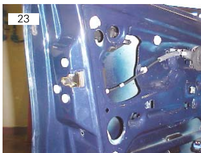
Conjunto trinco da porta vai fixado por meio de três parafusos torx 40
