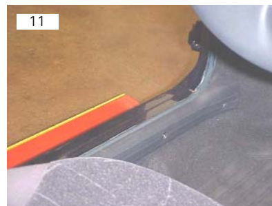
Moldura interna dianteira da soleira vai fixada por meio de parafusos philips
