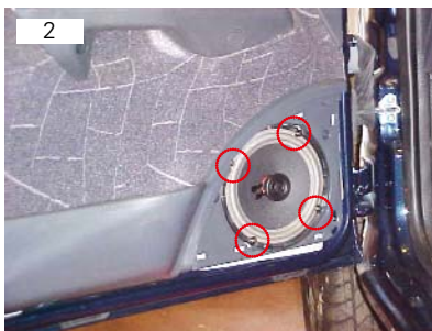
2 Alto-falante vai fixado por meio de quatro parafusos philips rosca soberba
