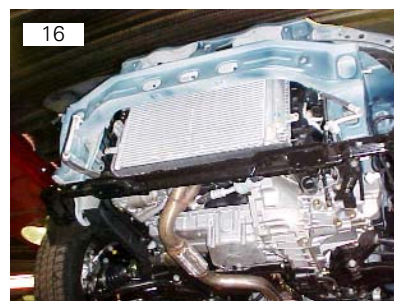
Localização dos dois parafusos M8 SEX13 de fixação do conjunto radiador
