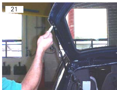
Soltar amortecedores da tampa traseira. Usar espátula plástica
