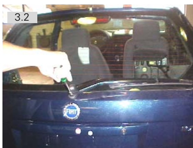
Remover porca M6 SEX10 de fixação do limpador traseiro
