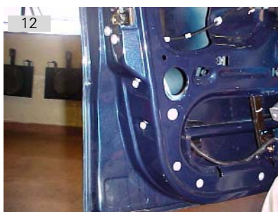
Guia do vidro vai fixado por meio de dois parafusos torx 40
