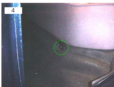
Localização do parafuso M6 SEX10 de fixação do banco traseiro
