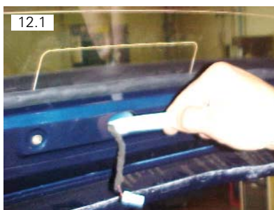
Soltar esguichador da tampa traseira. Usar espátula plástica
