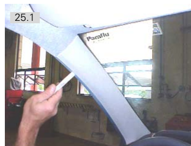
Soltar da moldura superior interna da coluna A. Usar espátula plástica
