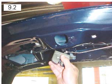
Remover conjunto trinco
