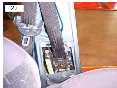
Localização do parafuso M6 SEX17 de fixação do cinto de segurança
