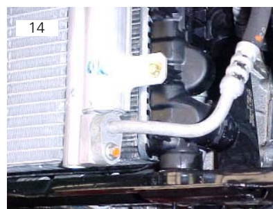
Tubulação inferior do ar condicionado vai fixada por meio de um parafuso M6 SEX10
