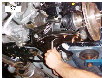
Remover quatro parafusos M12 SEX18 de fixação do agregado
