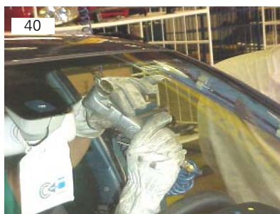
Remover pára-brisa. Usar ferramenta do tipo excalibur ou faca pneumática
