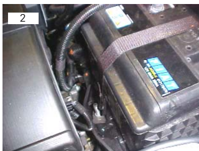
2 Localização da porca M6 SEX10 de fixação da cinta da bateria
