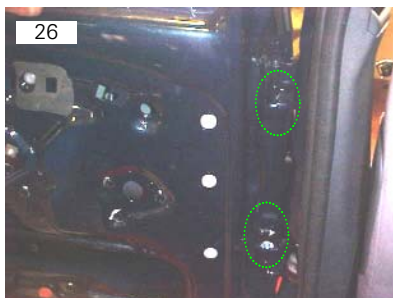
Porta traseira vai fixada por meio de dois parafusos M6 SEX10
