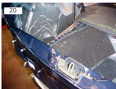
20 Localização das duas porcas M6 SEX10 de fixação do trinco batente da tampa traseira
