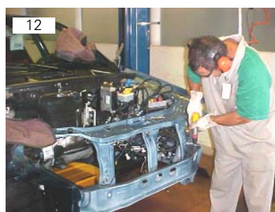
Despontear painel e travessa dianteira
