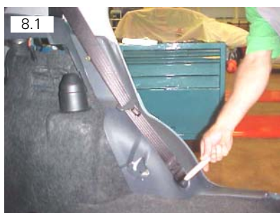
Soltar cobertura de acabamento do cinto de segurança. Usar espátula plástica
