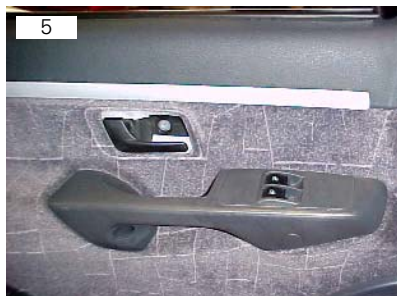
Comando elétrico da porta dianteira vai fixado por meio de encaixe
