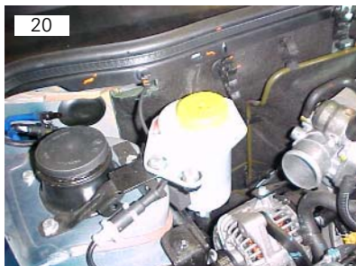
Reservatório de óleo da direção hidráulica vai fixado por meio de dois parafusos M8 SEX13
