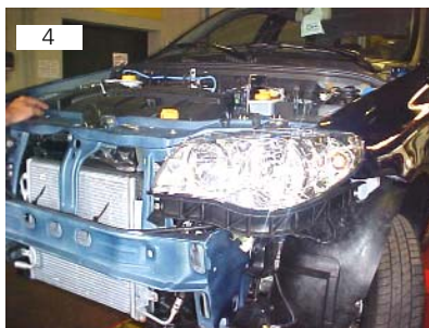
Suporte do pára-choque vai fixado por meio de três parafusos M6 SEX10
