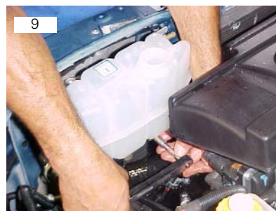
Remover parafuso M6 SEX8 de fixação do reservatório de expansão
