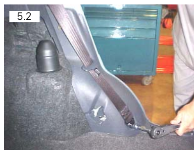
Remover parafuso M10 SEX17 de fixação do cinto de segurança
