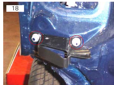
Localização das duas porcas M8 SEX13 de fixação do suporte do pára-choque
