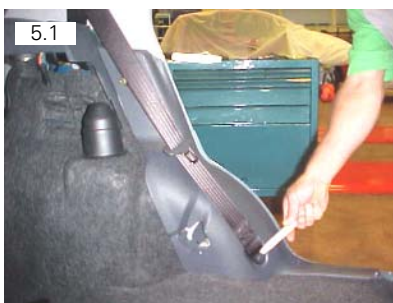
Soltar cobertura de acabamento do cinto de segurança. Usar espátula plástica
