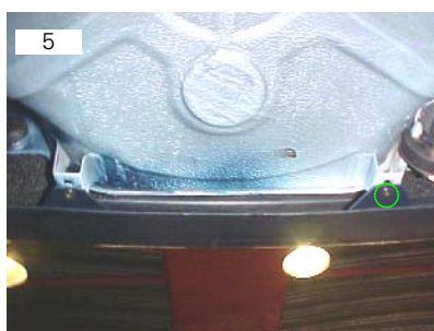
Pára-choque vai fixado na sua parte inferior por meio de dois parafusos torx 30
