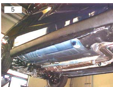
Saia lateral vai fixada por meio de seis parafusos M6 SEX8
