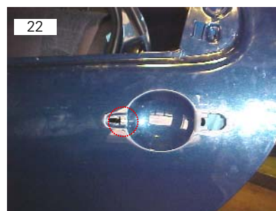
22 Localização do parafuso torx 20 de fixação do suporte da maçaneta externa
