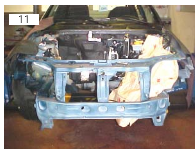
Painel e travessa dianteira vão fixados junto à carroceria por meio de pontos de solda por resistência
