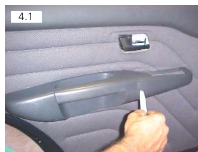
4.1 Remover tampão de acabamento. Usar espátula plástica
