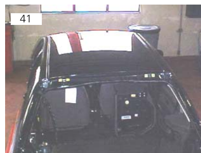
Teto vai fixado por meio de pontos de solda por resistência
