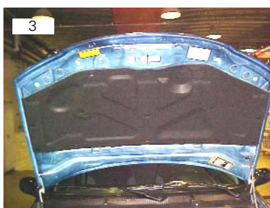
Forração do capô vai fixada por meio de 17 presilhas
