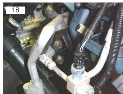
Localização do sensor de ar condicionado
