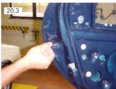
20.3 Remover parafusos de fixação da maçaneta externa
