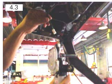
Desconectar chicote e remover máquina do limpador traseiro
