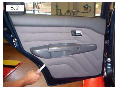
5.2 Soltar forração interna da porta traseira. Usar espátula plástica
