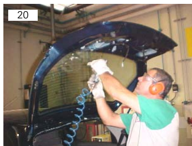
Remover vidro da tampa traseira. Usar ferramenta do tipo excalibur ou faca pneumática
