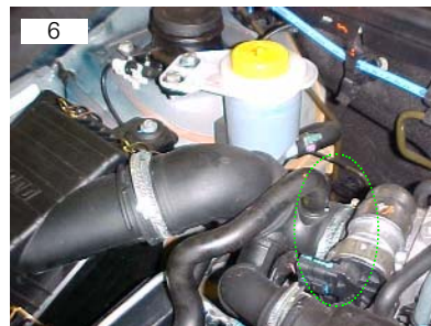
Localização da braçadeira de fixação da mangueira do filtro de ar
