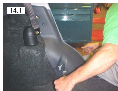
Soltar moldura inferior da coluna C. Usar espátula plástica
