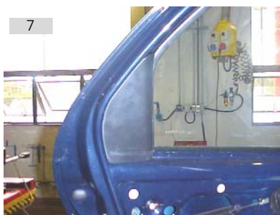
7 Moldura interna da porta vai fixada por meio de encaixe
