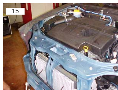
Localização dos dois parafusos M8 SEX13 de fixação do conjunto radiador
