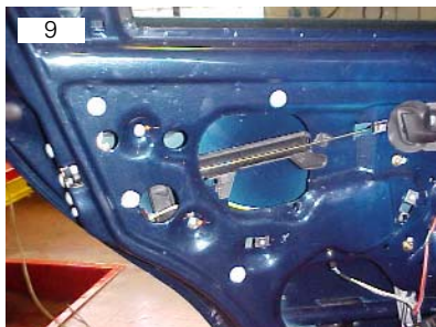
Guia da haste de acionamento da maçaneta interna da porta vai fixada por meio de encaixe
