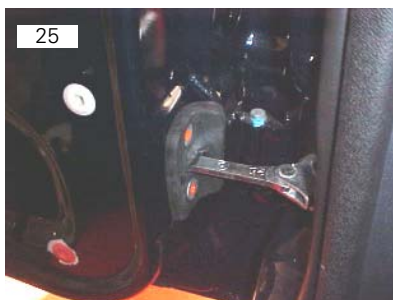
Limitador da porta vai fixado por meio de quatro parafusos torx 30
