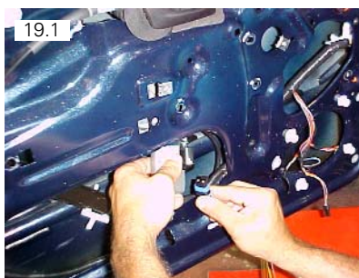
Desconectar chicote da máquina elétrica
