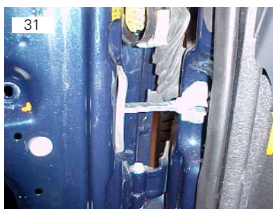
Limitador da porta é fixado por meio de quatro parafusos torx 30
