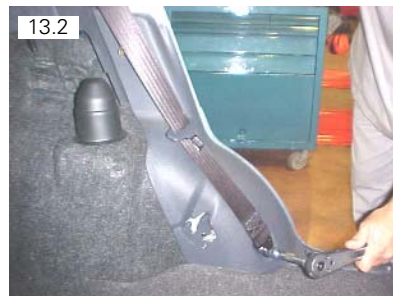
Remover parafuso M10 SEX17 de fixação do cinto de segurança
