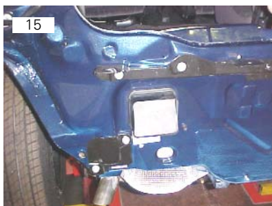
Aletas de respiro vão fixadas por meio de encaixe
