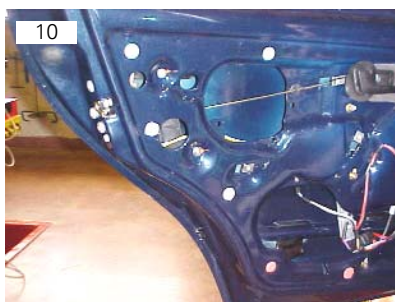
Coluna guia do vidro da porta traseira é fixada por meio de duas porcas M6 SEX10
