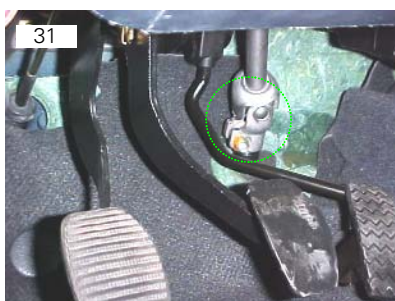
(*)Coluna de direção vai fixada por meio de um parafuso SEX13 passante e por uma porca M8 SEX13
