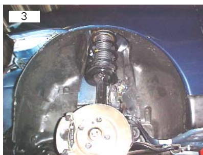
3 Pára-barro vai fixado por meio de parafusos
