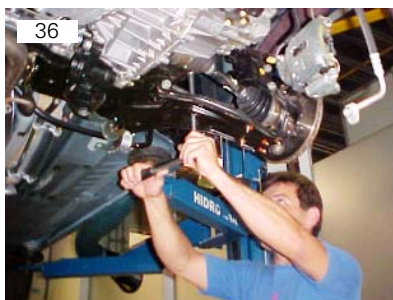
Remover quatro parafusos M10 SEX15 de fixação do agregado
