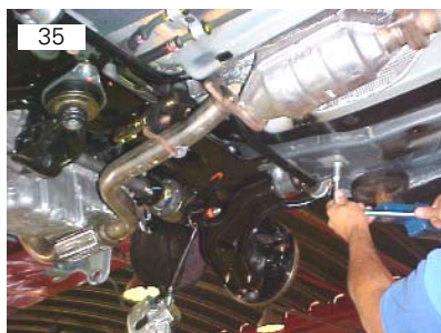
Remover parafusos de fixação do suporte da barra de direção
