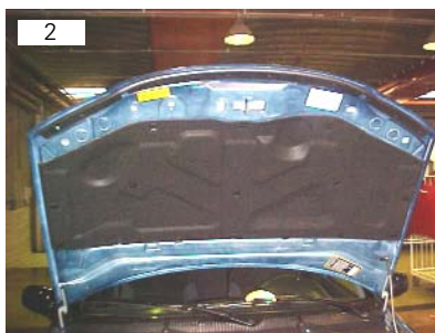
Guarnição do capô vai fixada por meio de presilhas
