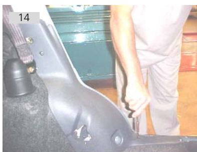
Remover quatro parafusos philips de fixação da moldura inferior coluna C
