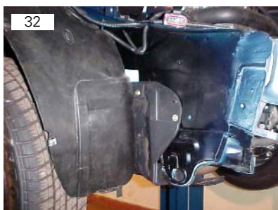
Proteção da polias vai fixada por meio de parafusos
