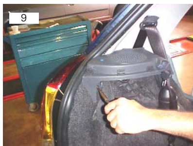
Remover três parafusos philips de fixação do suporte do porta-pacotes
