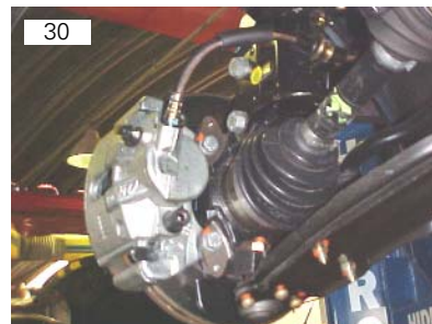
Pinça de freio vai fixada por meio de dois parafusos M10 SEX17, sendo uma pinça de cada lado
