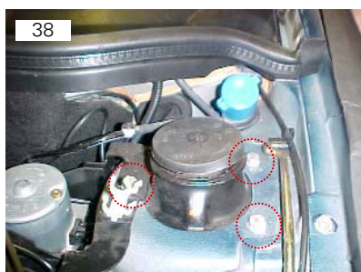
Torre do amortecedor vai fixada por meio de seis parafusos M8 SEX13, sendo três parafusos em cada torre
