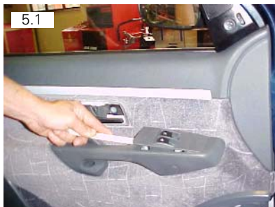
Soltar comando elétrico da porta dianteira. Usar espátula plástica
