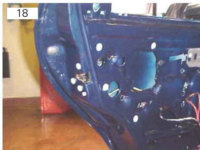
18 Conjunto trinco da porta traseira é fixado por meio de três parafusos torx 40
