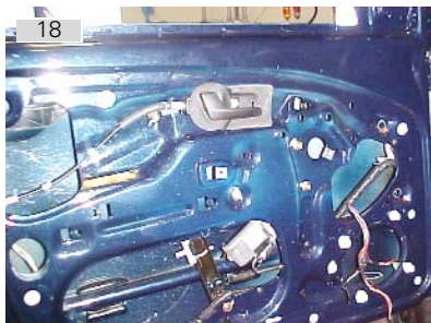
Máquina do vidro vai fixada por meio de duas porcas M6 SEX10
