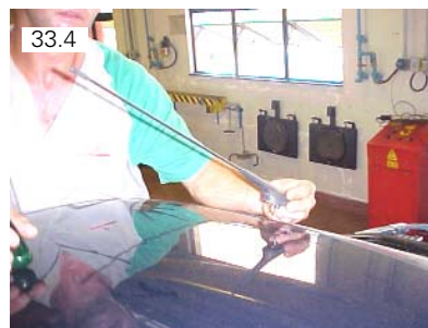
Remover antena do teto
