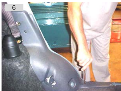
Remover quatro parafusos philips de fixação da moldura inferior coluna C
