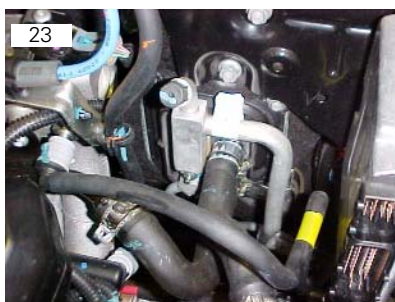
Mangueiras de ar quente do motor vão fixadas por meio de braçadeiras
