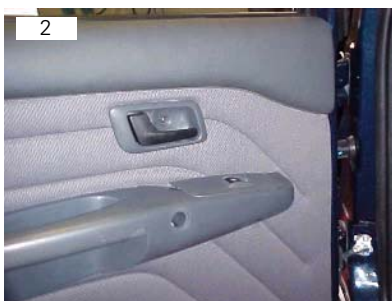
2 Localização do comando elétrico da porta
