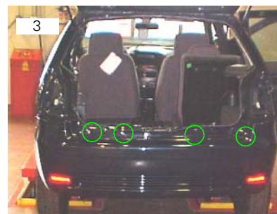
Localização dos quatro parafusos torx 30 de fixação do pára-choque traseiro
