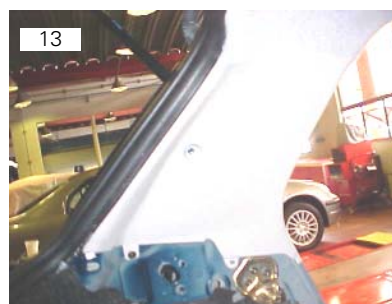
Moldura superior da coluna C vai fixada por meio de um parafuso philips
