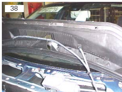
Localização das mangueiras dos esguichadores
