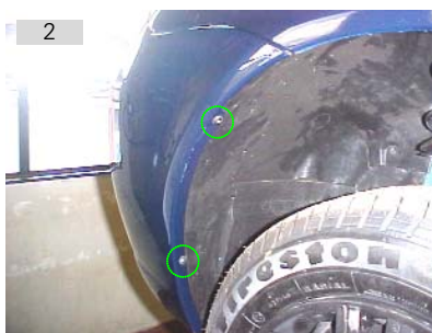
2 Localização dos dois parafusos philips rosca soberba
