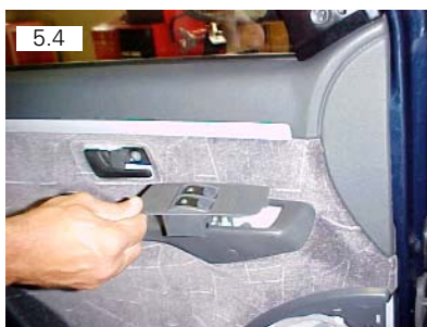
Remover comando elétrico da porta dianteira
