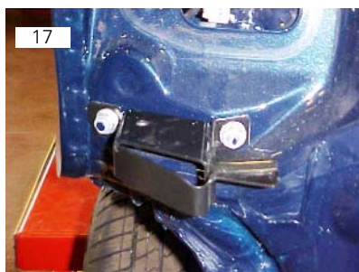
17 Localização das duas porcas M8 SEX13 de fixação do suporte do pára-choque
