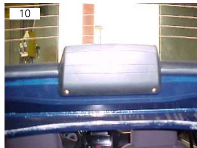
Break light vai fixado por meio de dois parafusos Allen 5
