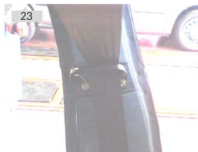
Localização dos dois parafusos torx de fixação do cinto de segurança
