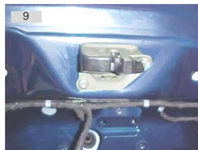
Localização dos dois parafusos Allen 5 de fixação do conjunto trinco da tampa traseira
