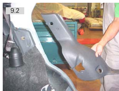
Remover moldura inferior da coluna C
