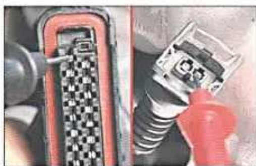
Fig. 4.1. Exemplo de verificação de continuidade no chicote do eletroinjeter (entre os bornes 2 do eletroinjeter 1 e 18 do MC).
