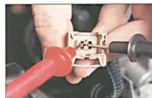
Fig. 2.1. Medida da tensão de alimentação do sensor ACT.
