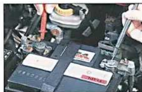
Fig. 1.2. Medida da tensão da bateria.
