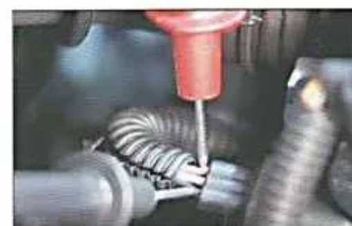
Fig. 1.2. Medida da tensão de resposta do sensor TPS.
