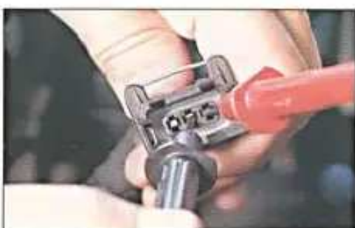
Fig. 2.1. Medida da tensão de alimentação do MAP.
