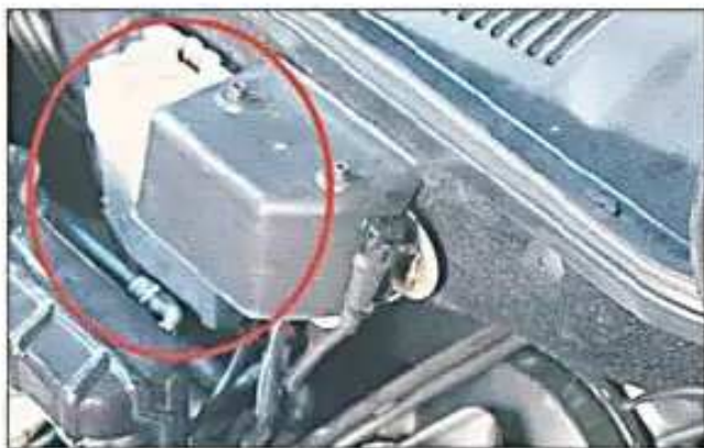
Fig. A. Localização do módulo de comando.
