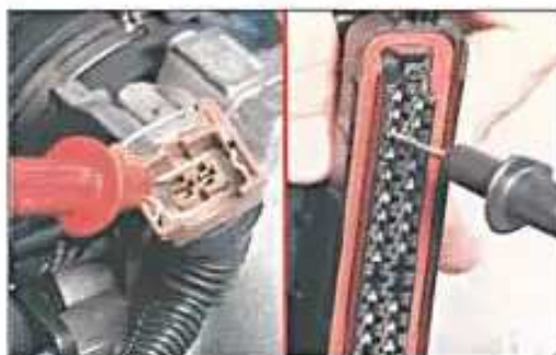
Fig. 4.1. Exemplo de verificação de continuidade no chicote do ACT (entre os bornes 1 do sensor e 16 do MC).
