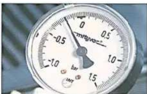
Fig. 1.2. Depressão de 0,2 bar aplicada no MAP.
