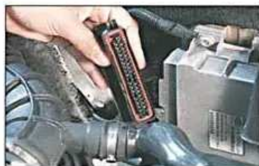
Fig. 2.a. Terminal elétrico do MC.
