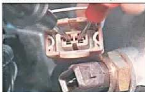
Fig. 4.2. Verificação de curto-circuito no chicote do ACT (entre os bornes 1 e 2 do chicote).
