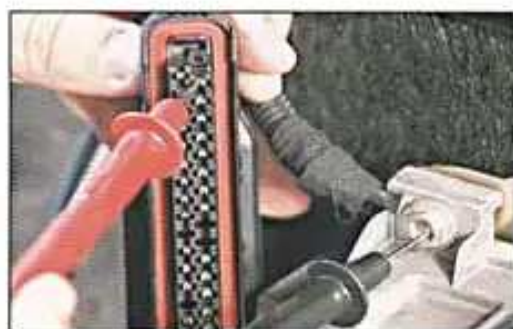
Fig. 2.5. Medida da tensão de alimentação do MC.
