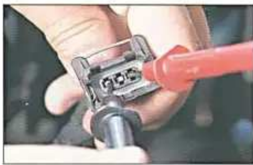
Fig. 4.2. Exemplo de verificação de curto-circuito no chicote do MAP (entre os bornes 1 e 3 do terminal elétrico do MAP).
