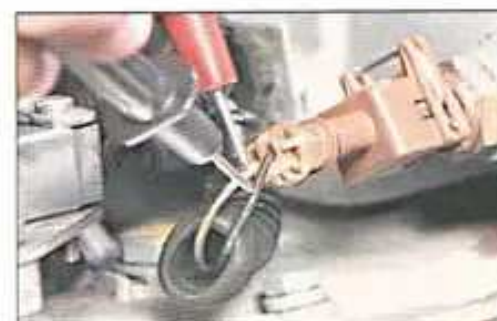
Fig. 1.1. Medida da tensão nominal do sensor ACT.
