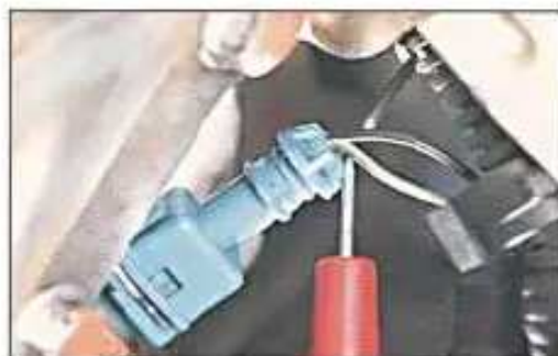
Fig. 1.1. Medida da tensão nominal no sensor ECT.
