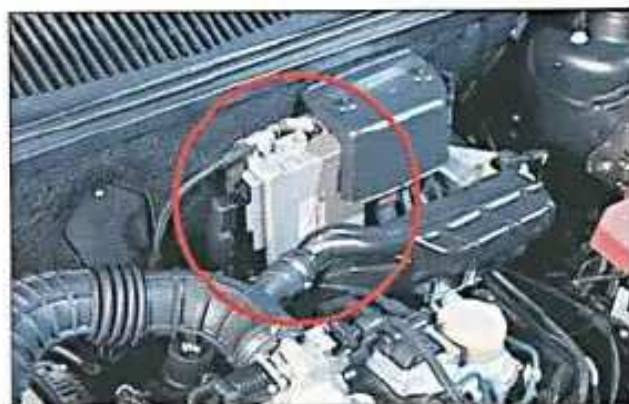
Fig. A. Localização do MC: No compartimento do motor, na parede corta-fogo do veículo.
