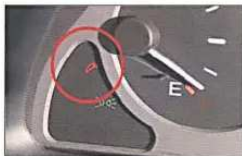
Fig. B. Localização da lâmpada de advertência no painel do veículo.
