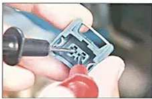
Fig. 1.1. Medida da tensão nominal no sensor ECT.
